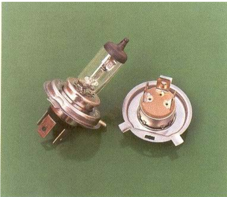
Fig. 36: Lampada bilux per auto. Viene eseguita una saldatura multipla. Tramite diverse proiezioni la lampada viene saldata a una corona esterna. Per ogni proiezione viene impiegata una piccola testa di saldatura (delle dimensioni di un pacchetto di sigarette). Sono presenti saldature anche all'interno del bulbo. I diversi tipi di lampade sono tra i pezzi che meglio si adattano a essere lavorati con saldatrici a resistenza.
