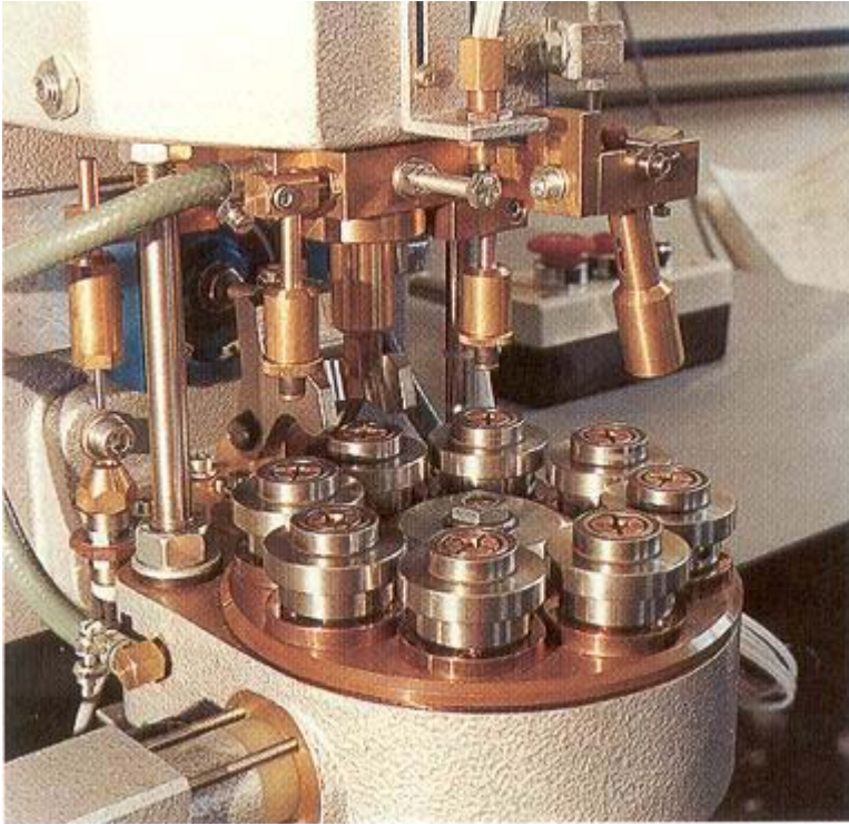
Fig. 33 Saldatrice semiautomatica a tavola rotante
