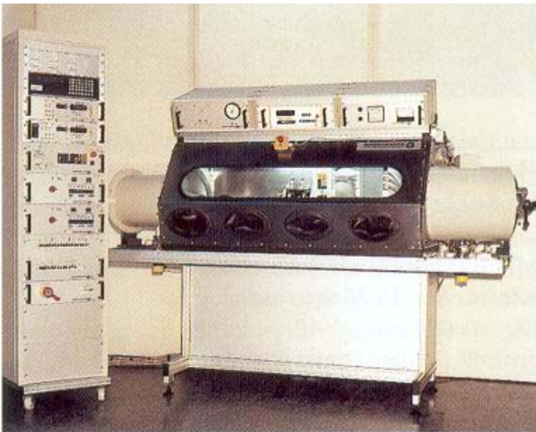
Fig. 40: Impianto con camera climatizzata al cui interno è disposta una saldatrice parallel gap in esecuzione a rulli, per la cucitura ermetica di custodie metalliche a basette di componenti della microelettronica
